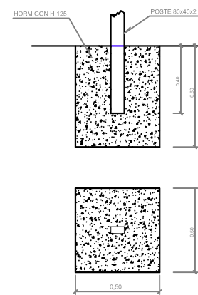
CIMENTACION PARA POSTE DE SEÑALES
